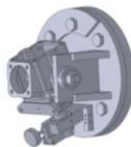
Рис. 4 – 3-D модель спеціального токарного пристрою з деталлю та встановленою протизвагою
