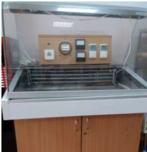
Рисунок 1 – Розроблена лабораторна установки для дослідження температурно -енергетичних параметрів холодильної вітрини з автоматизованою системою керування
