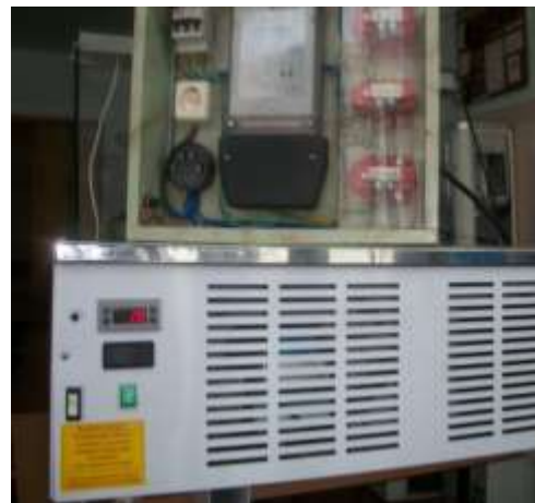
Рисунок 1 – Розроблена лабораторна установки для дослідження температурно -енергетичних параметрів холодильної вітрини з автоматизованою системою керування
