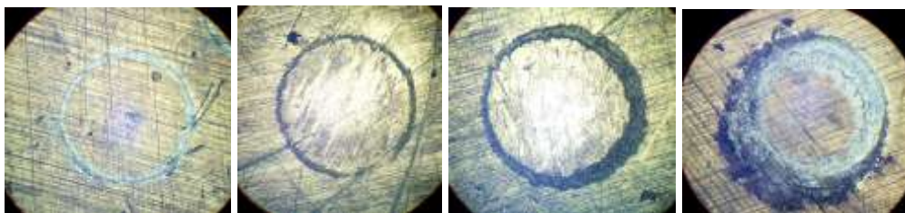
Рис. 2. Фретинг-контакт площини з кулькою. Початкова амплітуда відносного проковзування A_n = 5 мкм, кінцева A_k = 20 мкм: а – A=5 мкм 0,1 \cdot 10^5 ; б – A=10 мкм 10 \cdot 10^5 ; в – A=15 мкм 15 \cdot 10^5 ; г – A=20 мкм 60 \cdot 10^5 циклів.
